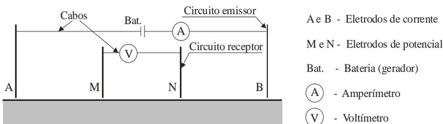
**Figura A** – Representação esquemática dos circuitos emissor (bateria, eletrodos A e B e amperímetro) e receptor (eletrodos M e N e voltímetro).
