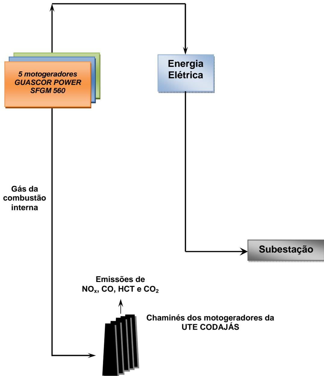
Figura 4.2- Fluxograma do processo de produção de energia elétrica da UTE CODAJÁS a gás natural.
