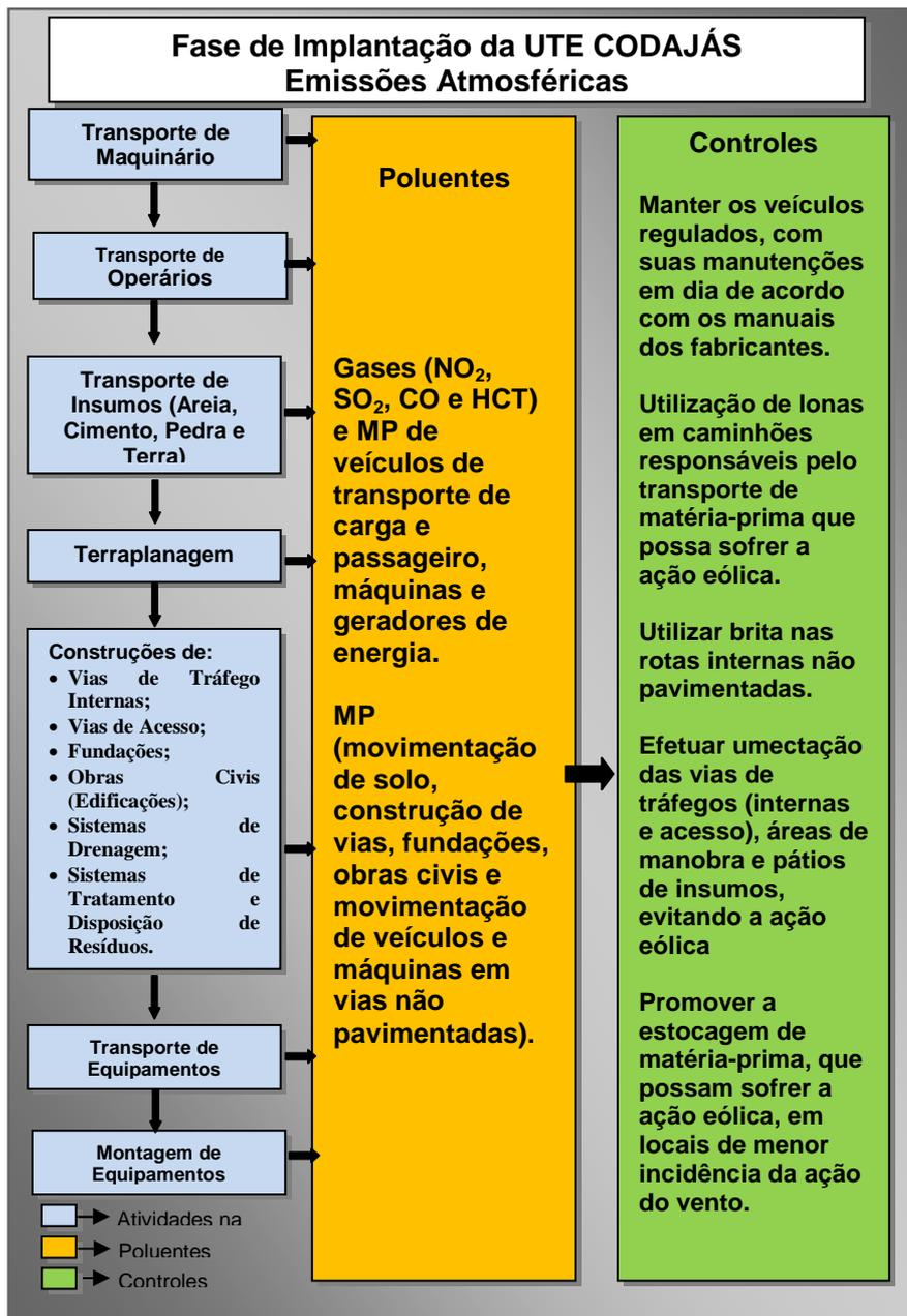
**Figura 4.1-** Fluxograma da fase de implantação da UTE CODAJÁS – fontes, emissões de poluentes atmosféricos e seus sistemas de controle.
