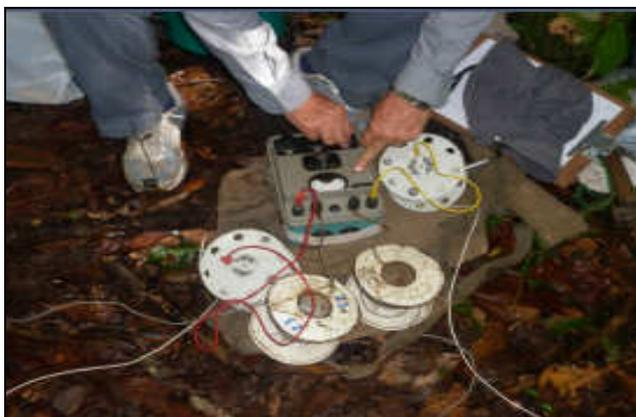
Foto 6– Equipamentos utilizados para medir a resistividade do solo.
