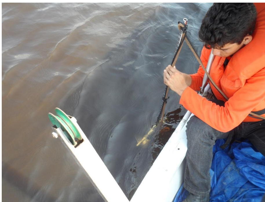
Foto 36. Medição de velocidade do Rio Negro com molinete fluviométrico acoplado a contador digital de velocidade
