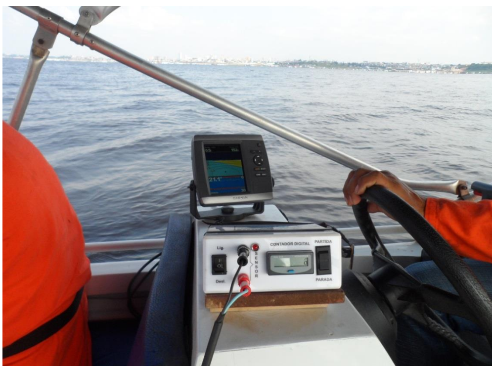
Foto 34. Contador digital de velocidade de água e Ecobatímetro Georreferenciado. Equipamentos utilizados para o levantamento de dados hidrológicos e batimétricos da ADA e AID do empreendimento no Rio Negro
