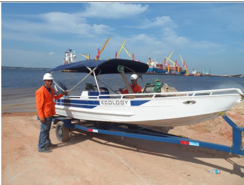
Foto 33. Embarcação utilizada para o levantamento hidrológico e batimétrico na AID e ADA do empreendimento no Rio Negro
