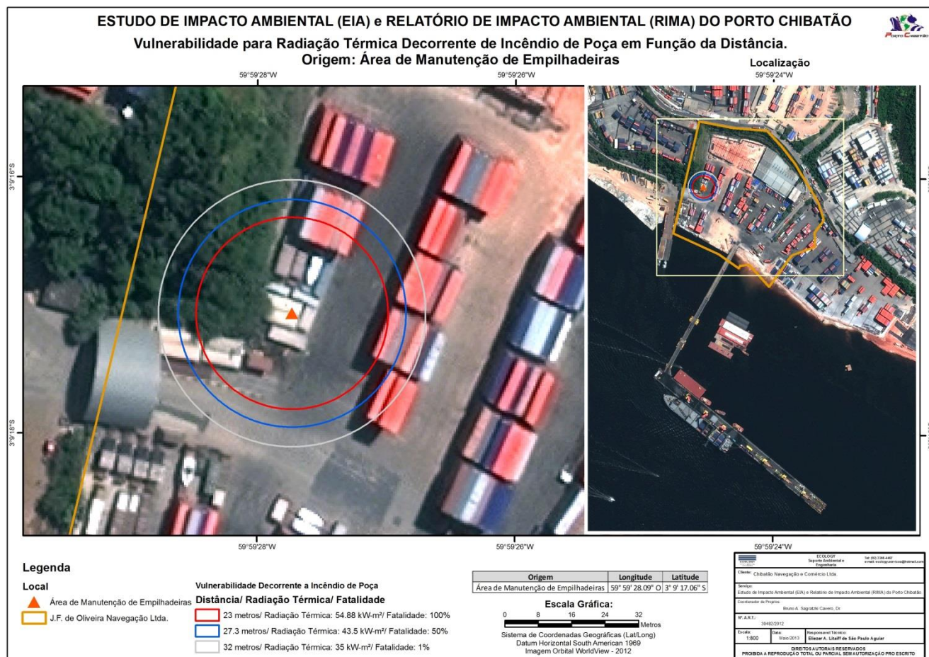
Figura 10. Efeito da radiação térmica decorrente de incêndio em poça com origem na Área de Manutenção de Empilhadeiras do Porto Chibatão (Chibatão Navegação e Comércio Ltda.) Manaus, AM.
