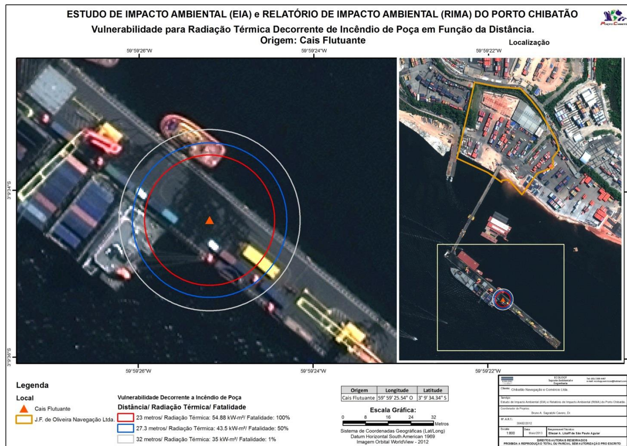
Figura 8. Efeito da radiação térmica decorrente de incêndio em poça com origem no Cais Flutuante do Porto Chibatão (Chibatão Navegação e Comércio Ltda.) Manaus, AM.
