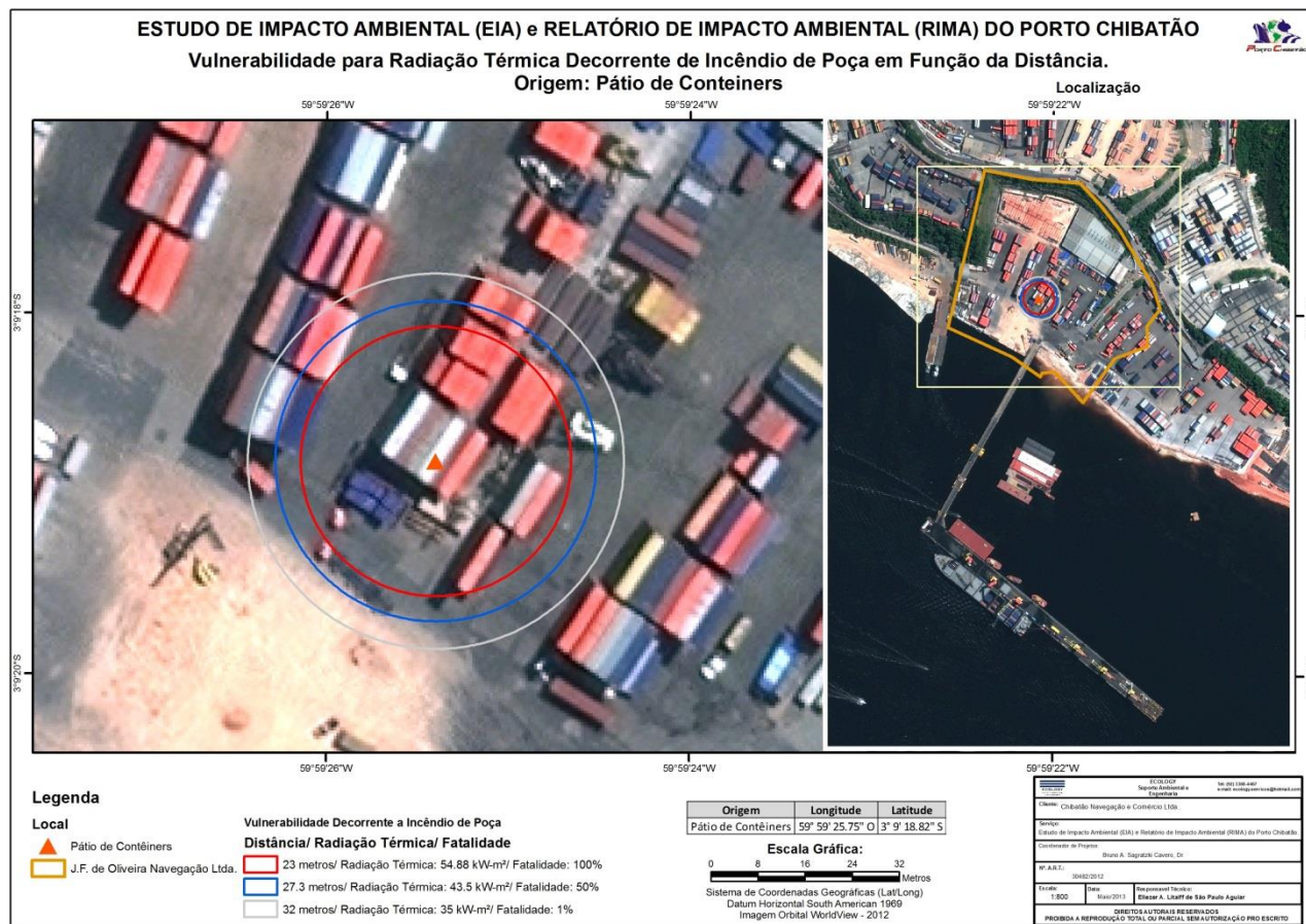
Figura 9. Efeito da radiação térmica decorrente de incêndio em poça com origem no Pátio de Containers do Porto Chibatão (Chibatão Navegação e Comércio Ltda.) Manaus, AM.
