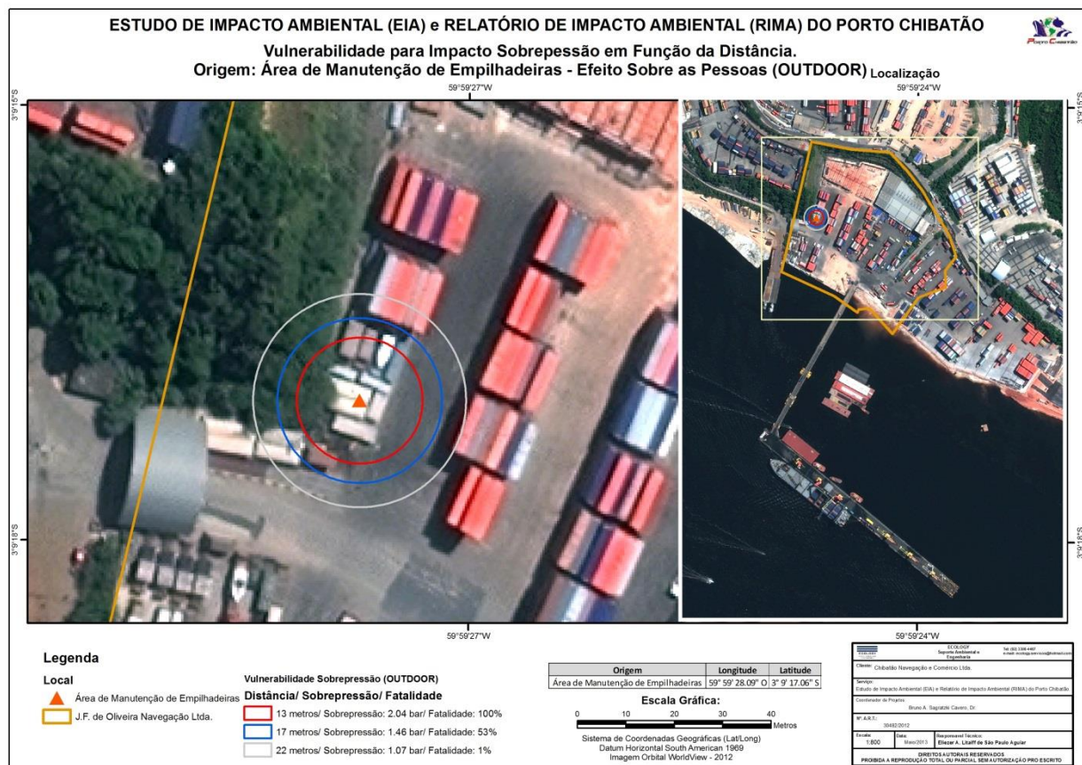
Figura 14. Efeito de sobrepressão decorrente de explosão de nuvem não confinada originada na Área de Manutenção de Empilhadeiras do Porto Chibatão (Chibatão Navegação e Comércio Ltda.) Manaus, AM.
