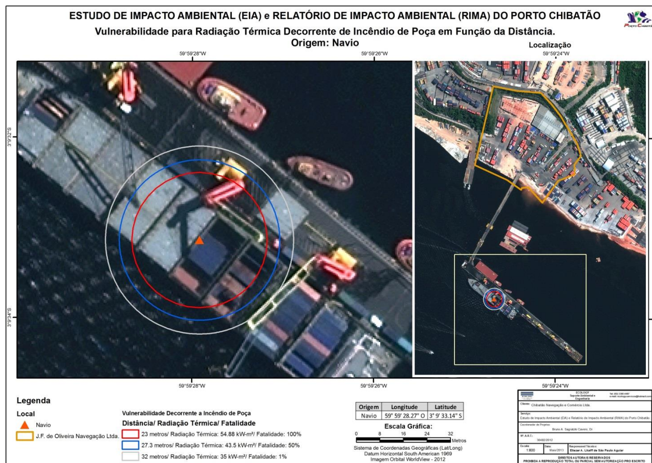
Figura 7. Efeito da radiação térmica decorrente de incêndio em poça com origem em Navio Aportado no Cais Flutuante do Porto Chibatão (Chibatão Navegação e Comércio Ltda.) Manaus3, AM
