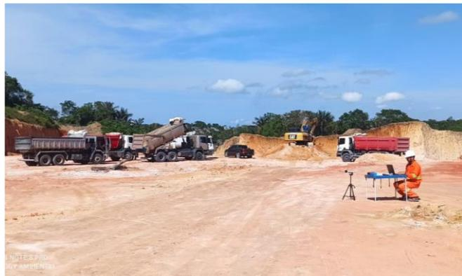
Foto 11. Verificação de emissões sonoras (ruído) durante as atividades de operação (medição realizada na porção superior da cava)
