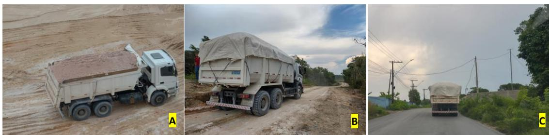
Foto 19. Fases da operação do transporte. Modal rodoviário. A) Transporte interno; B) Colocação da lona de proteção contra poeiras; C) Transporte externo. No detalhe o caminhão lonado.
