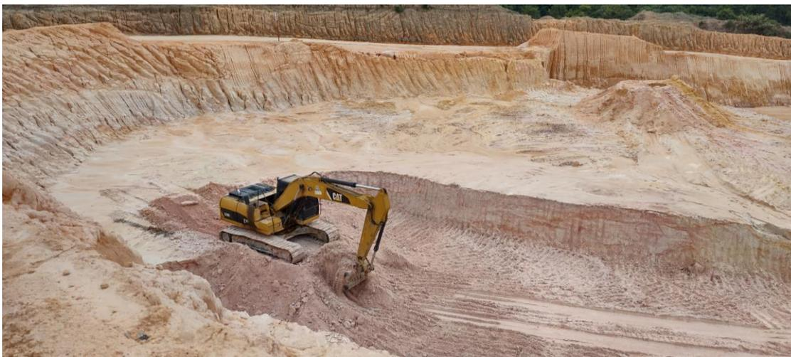
Foto 12. Escavação de argila realizada por escavadeira hidráulica na área da mina da Polimix Concreto Ltda.
