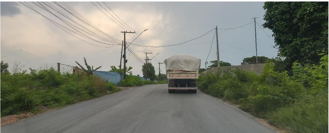
Foto 16. Transporte de argila por caminhão do tipo caçamba em via pública (estrada do Puraquequara). Observar que o caminhão está protegido por lona para evitar a emissão de poeira.
