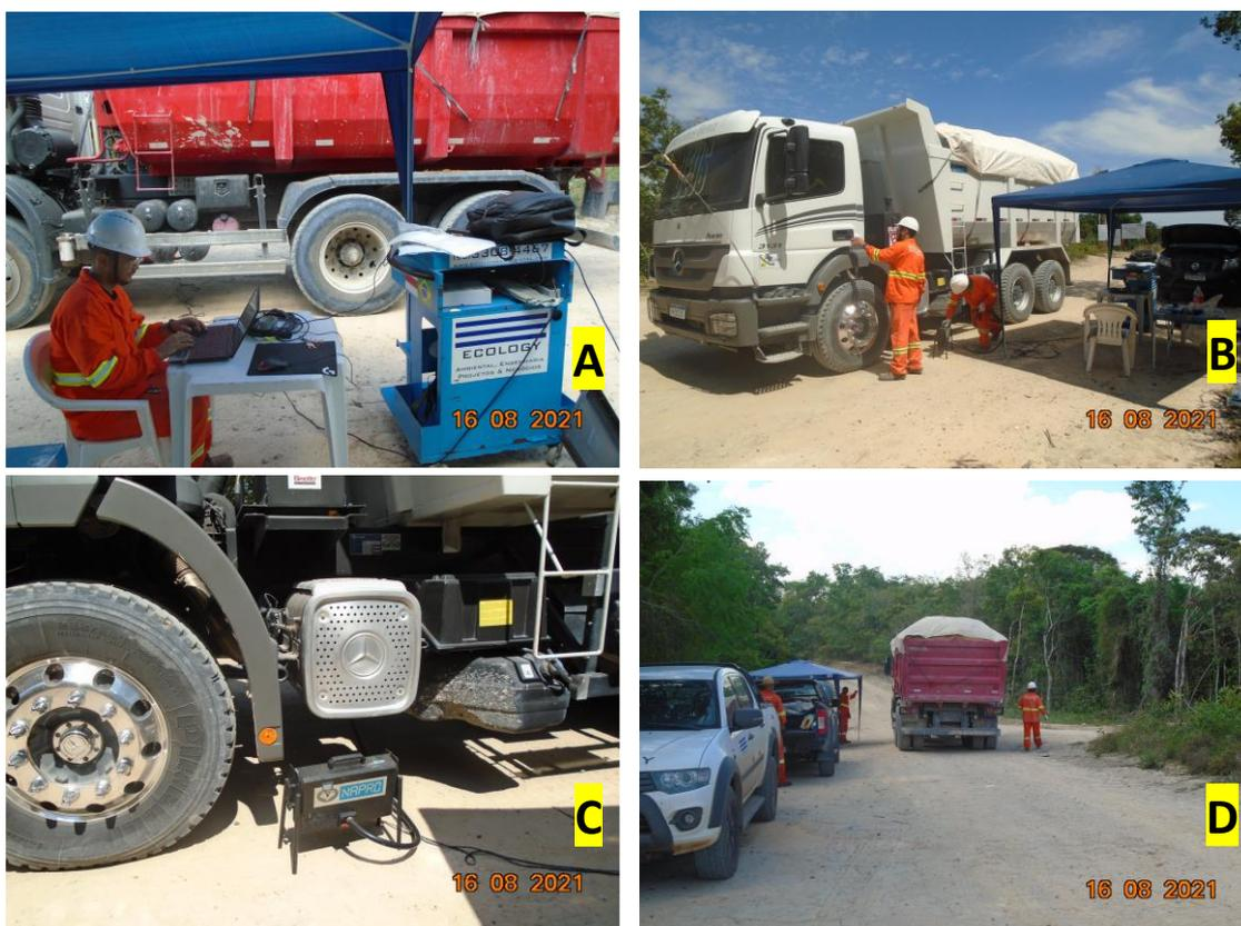
Foto 20. Monitoramento de opacidade nos equipamentos que operam nas atividades da mina. A e B) Instalação de equipamentos de monitoramento de opacidade; C) Detalhe do opacímetro; D) Barreira de monitoramento.
