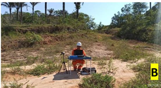
Foto 24. Verificação de emissões sonoras (ruído) no momento “com atividades de operação”. A: Medição de ruído porção superior da cava (PMR – 02); B: Medição do ruído no setor sul empreendimento (PMR – 04).
