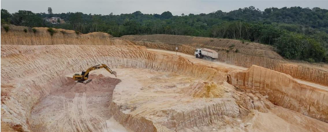
Foto 14. Escavação por escavadeira hidráulica e transporte de argila por caminhão do tipo caçamba na área da mina da Polimix Concreto Ltda.
