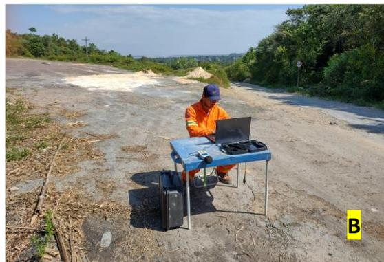
Foto 23. Verificação de emissões sonoras (ruído) no momento “sem atividades de operação”. A: Medição de ruído no interior da cava (PMR – 03); B: Medição do ruído no acesso ao empreendimento (PMR – 01).
