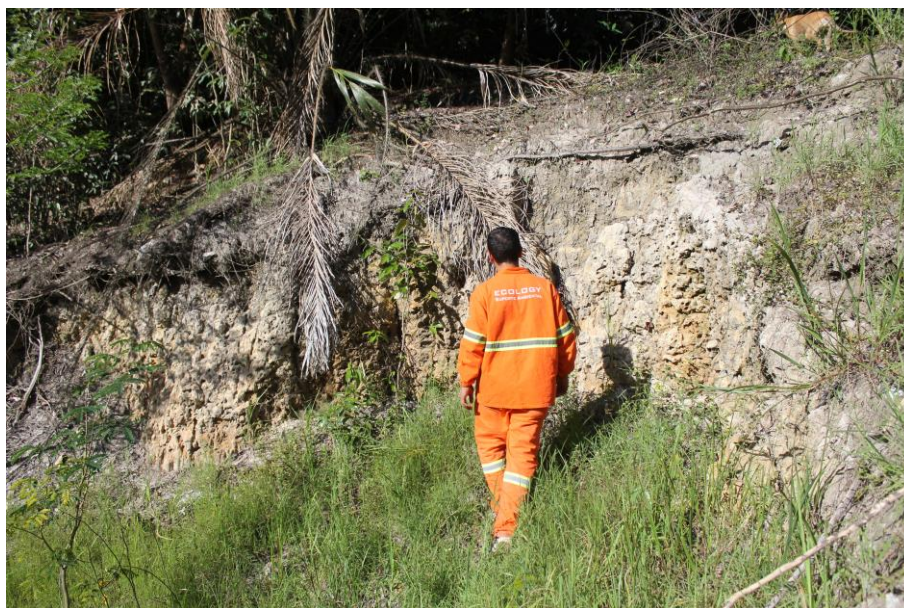
Foto 8. Afloramento de sedimentos inconsolidados (solo Aluvial), caracterizado pela cor acinzentada devido a presença de matéria orgânica.
