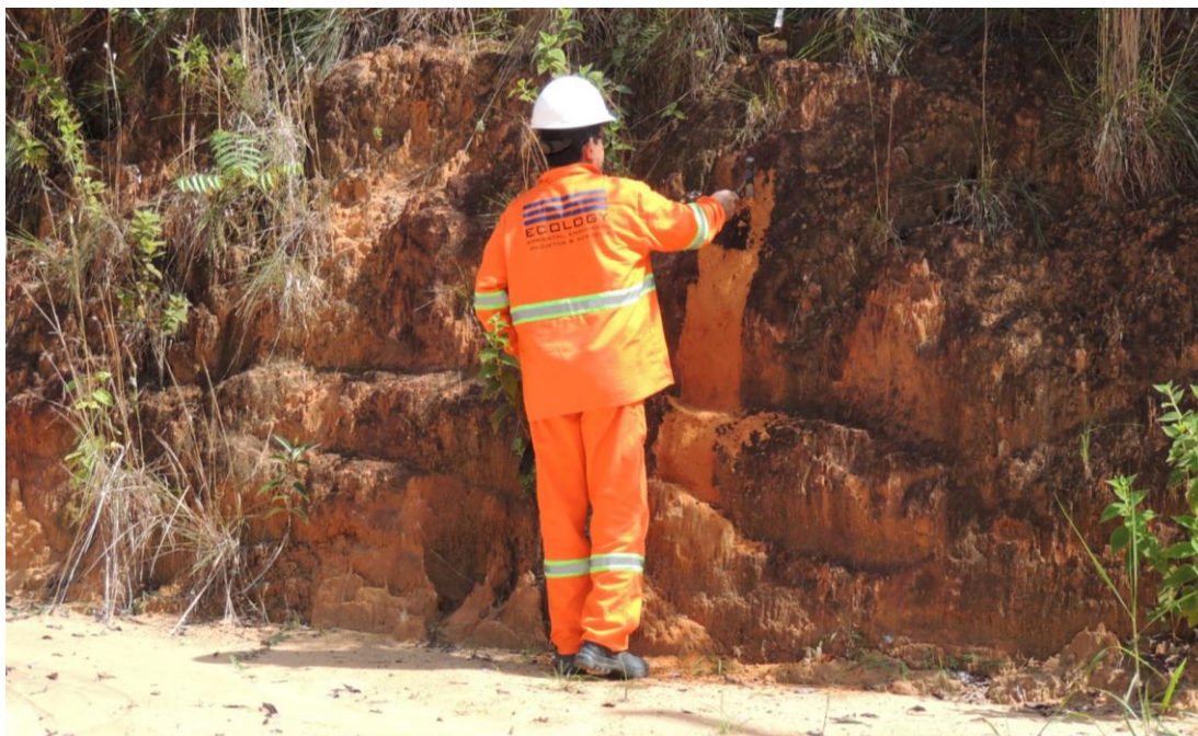
Foto 41. Perfil de Latossolo em corte de estrada vicinal no interior da área.
