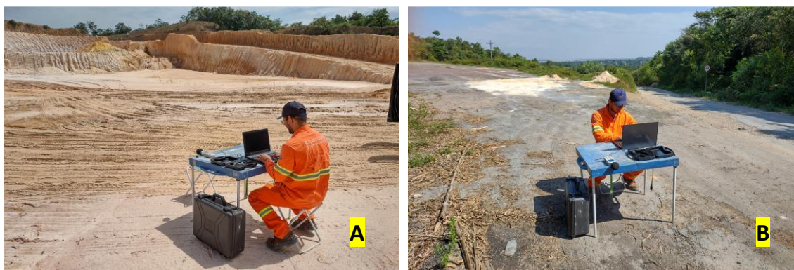
Foto 2. Verificação de emissões sonoras (ruído) no momento “sem atividades de operação”. A: Medição de ruído no interior da cava (PMR – 03); B: Medição do ruído no acesso ao empreendimento (PMR – 01).
