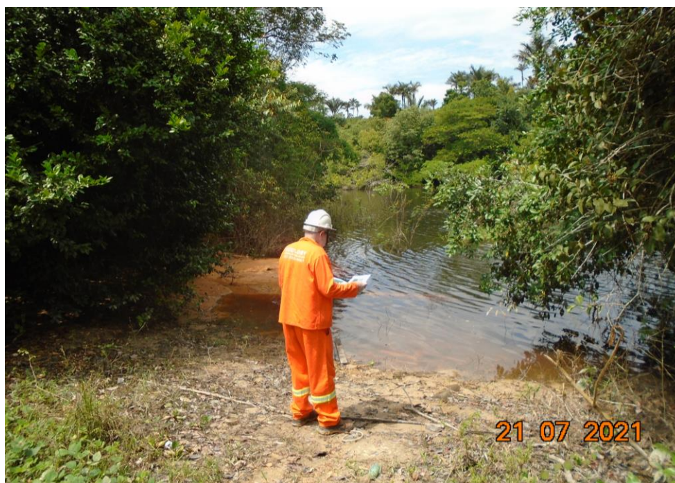
Foto 39. Solo do tipo Neossolo Flúvico Eutrófico, rico em matéria orgânica encontrado nas margens do fundo das drenagens.
