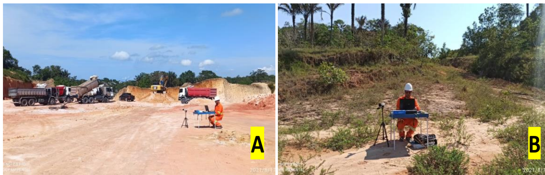
Foto 3. Verificação de emissões sonoras (ruído) no momento “com atividades de operação”. A: Medição de ruído porção superior da cava (PMR – 02); B: Medição do ruído no setor sul empreendimento (PMR – 04).
