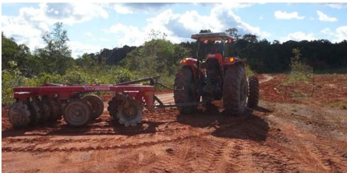
Foto 1. Modelo de trator e grade agrícola a ser usada no preparo da área do plantio.
