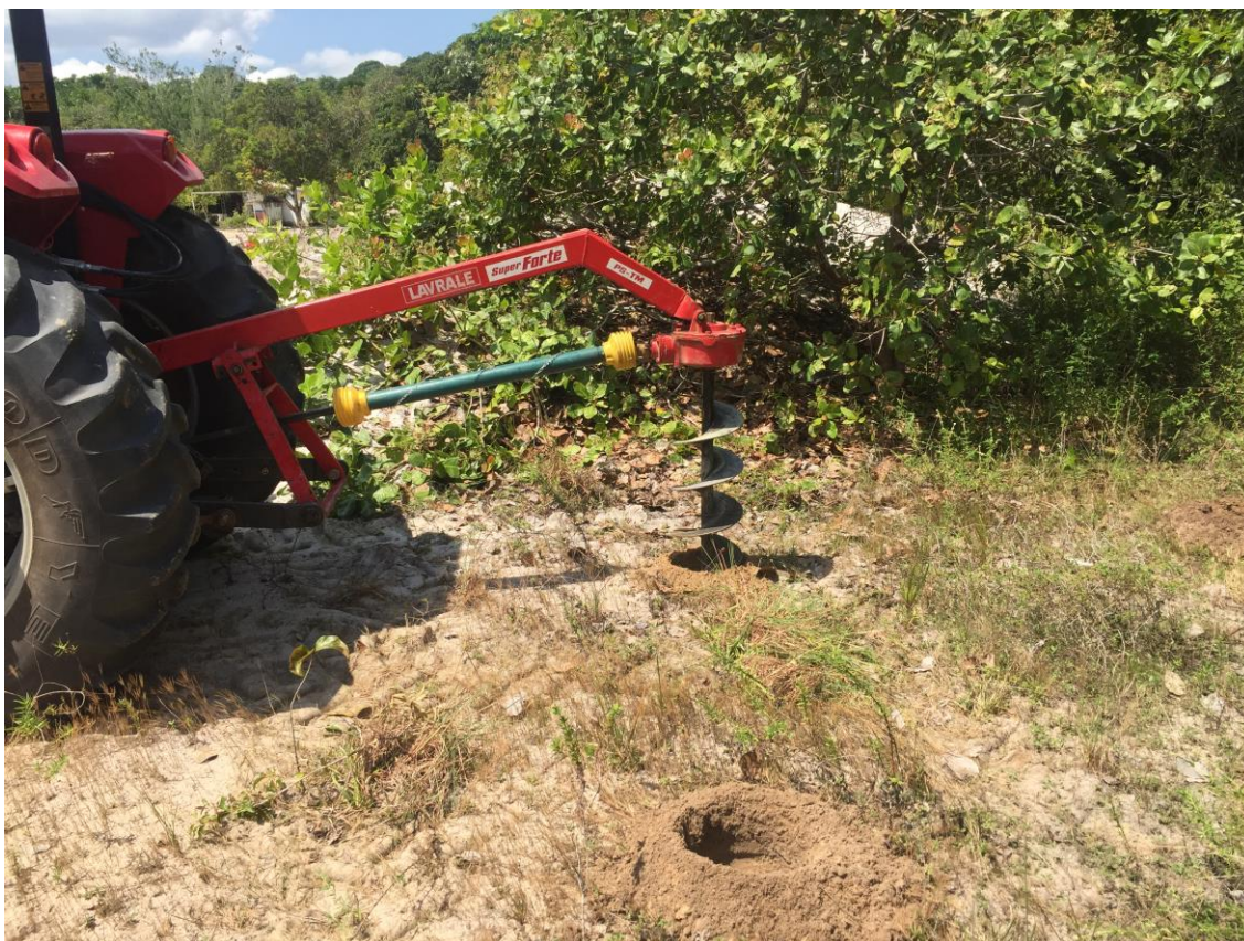
Foto 10. Opção de abertura de covas por meio mecanizado (uso de trator agrícola perfurador de solo).
