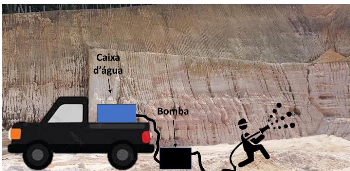
Figura 5: Esquema representativo da hidrossemeadura nos taludes da cava
