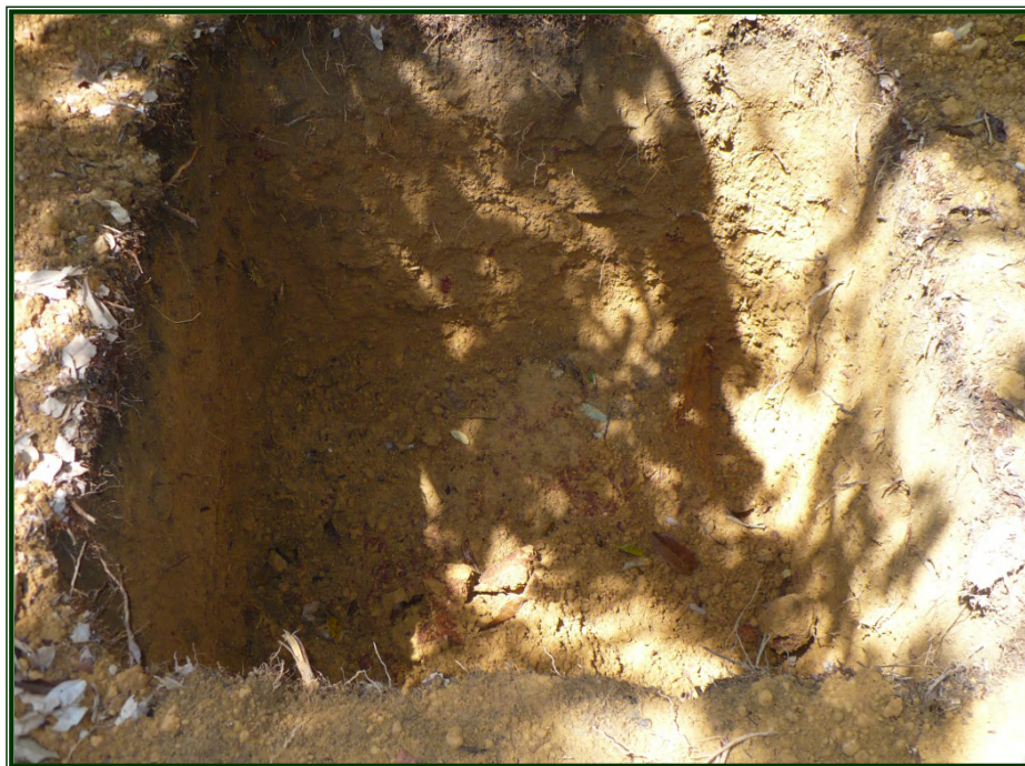
Figura 26 - – Detalhe do Furo de Sondagem 4, profundidade 1,0m. A – Solo argiloso. B – Solo laterítico (topo da zona de concreções). Coordenadas Geográficas (60° 9' 36,525" W; 3° 8' 46,928" S). Material laterítico apropriado para aterro e pavimentação (material de empréstimo).
