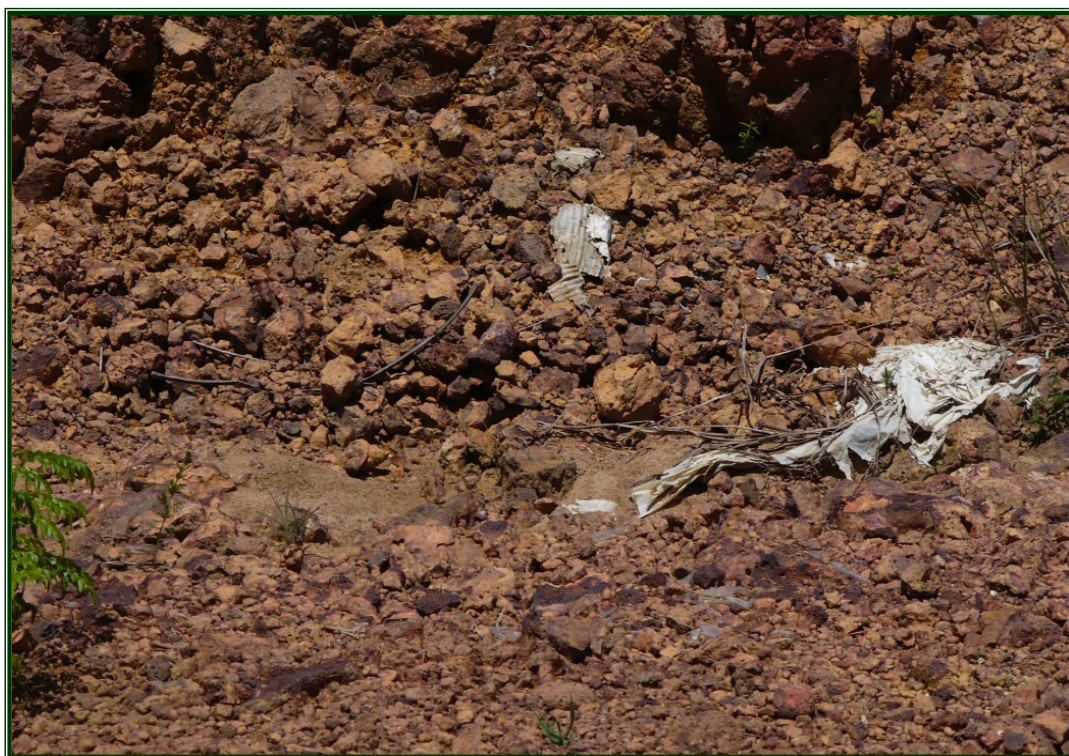
Figura 32 – Detalhe da granulação grosseira do material laterítico apropriado para aterro e pavimentação (material de empréstimo).
