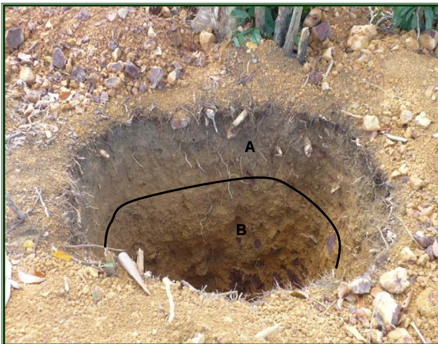
Figura 24 - Detalhe do Furo de Sondagem 1, profundidade 1,40m. A – Solo argiloso. B – Solo laterítico. Coordenadas Geográficas (60° 9' 19,710" W; 3° 8' 47,987" S). Material laterítico apropriado para aterro e pavimentação (material de empréstimo).
