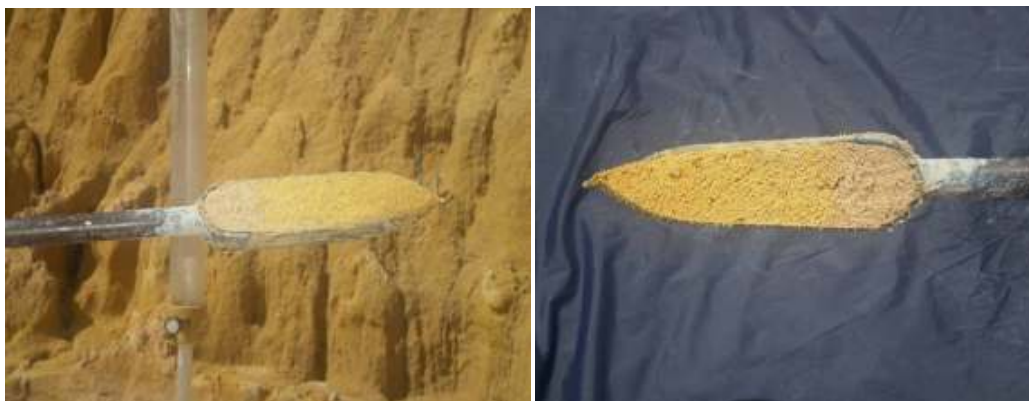
Figura 35. Obtenção de amostras de solo deformadas por meio de trado manual.
