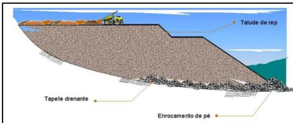
Figura 1.9.1.5.5.3.3-2 - Demonstração de uma pilha sendo feita sobre seu tapete drenante.
