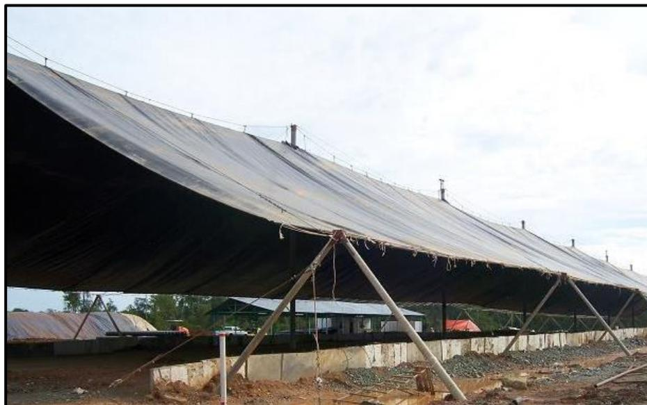
Foto 1.9.1.1-1 - Exemplo de tenda utilizada para armazenamento de minério ROM para secagem
