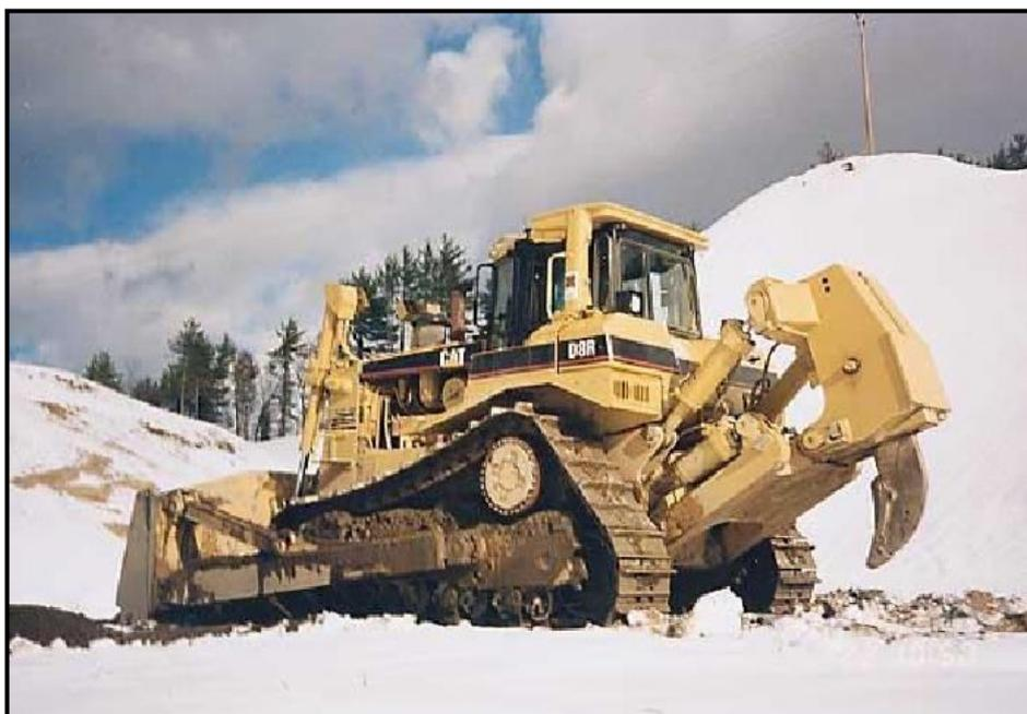
Foto 1.8.2.4.2-1 - Imagem ilustrativa de um trator de esteiras utilizado na retirada de solo orgânico.
