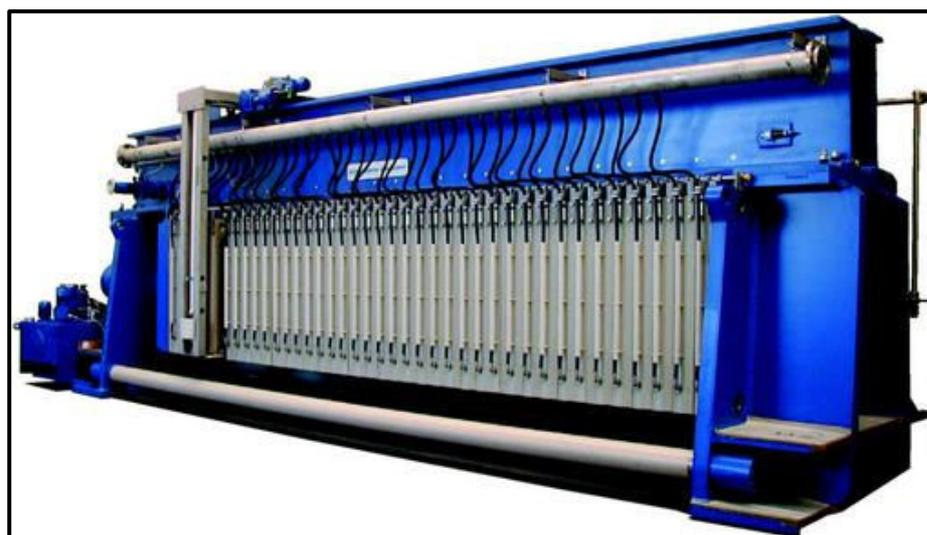
Foto 1.9.1.4.1-3 - Exemplo de filtro prensa automatizado.
