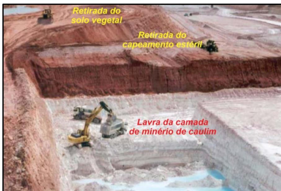
Figura 1.8.2.5-1 – Visão geral de exemplo de operações de lavra de minério de caulim.
