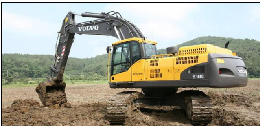
Foto 1.8.2.4.3-1 - Imagem ilustrativa de uma escavadeira de 36 t a ser utilizada na operação de decapeamento e lavra.
