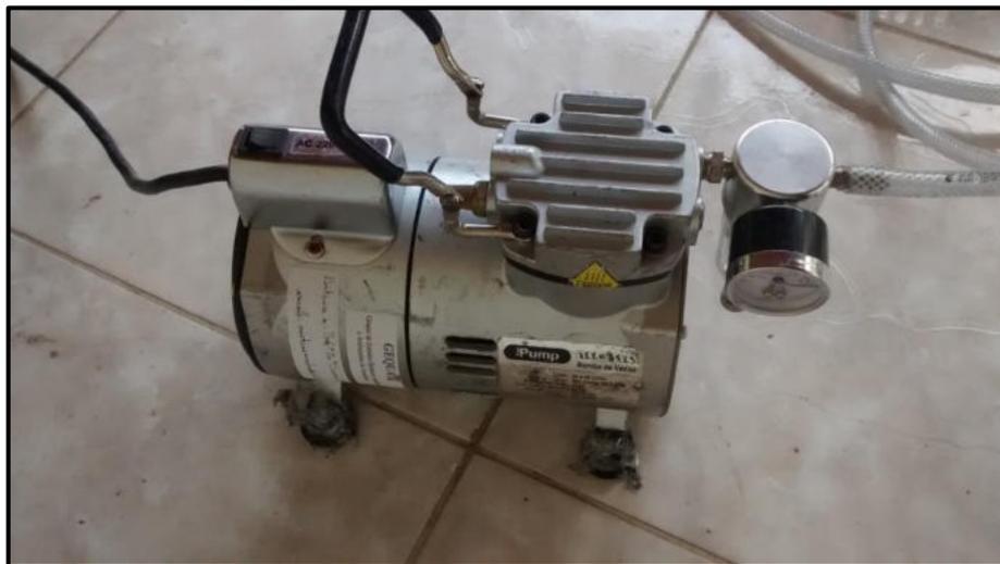
Foto 13 – Bomba Amostradora de NOx e SOx.
