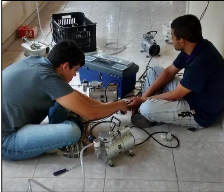
Foto 14 – Montagem de Calibradores de Amostrador de NOX e SOx.
