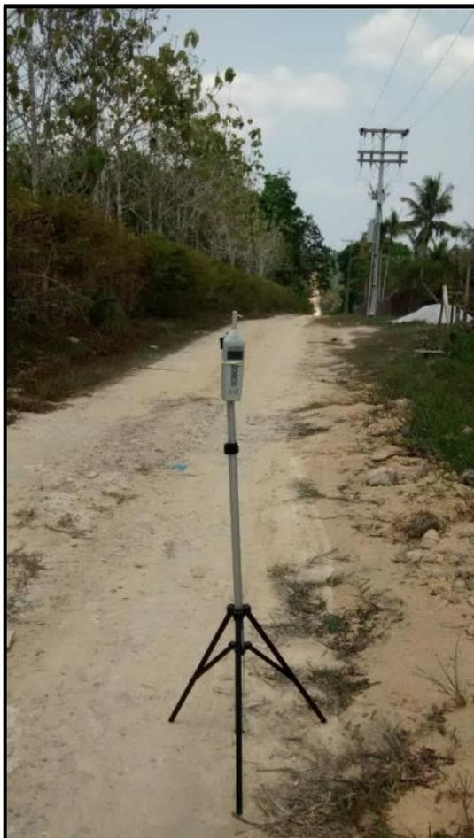
Foto 4.1.4.2.2-1 - Imagem da amostragem durante medição de ruído no ponto P1(Diurno).
