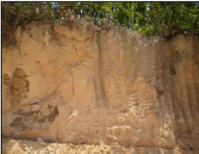
Foto 4.1.6.2-1 - Perfil de latossolo em corte de estrada vicinal no interior da área.
