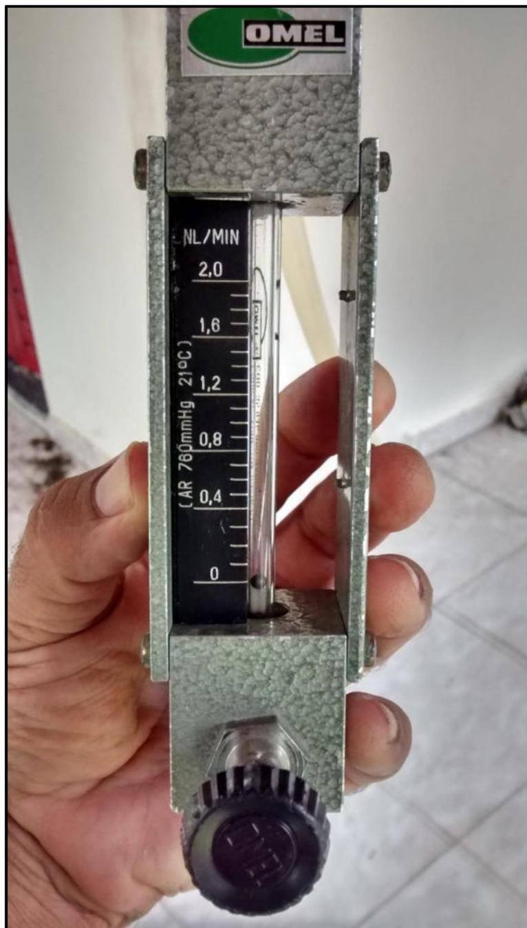
Foto 15 – Calibradores de Amostrador de NOx e SOx.
