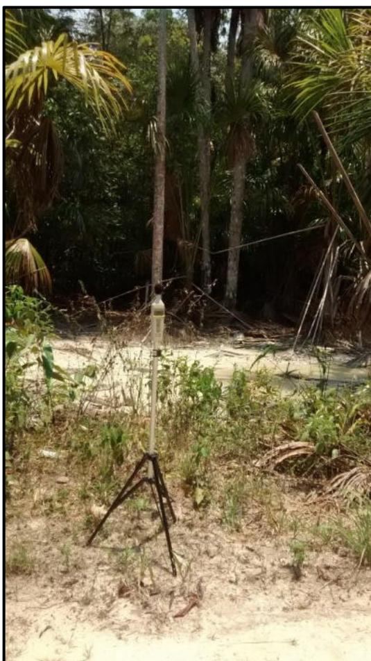
Foto 4.1.4.2.2-2 - Imagem da amostragem durante medição de ruído no ponto P2 (Diurno).
