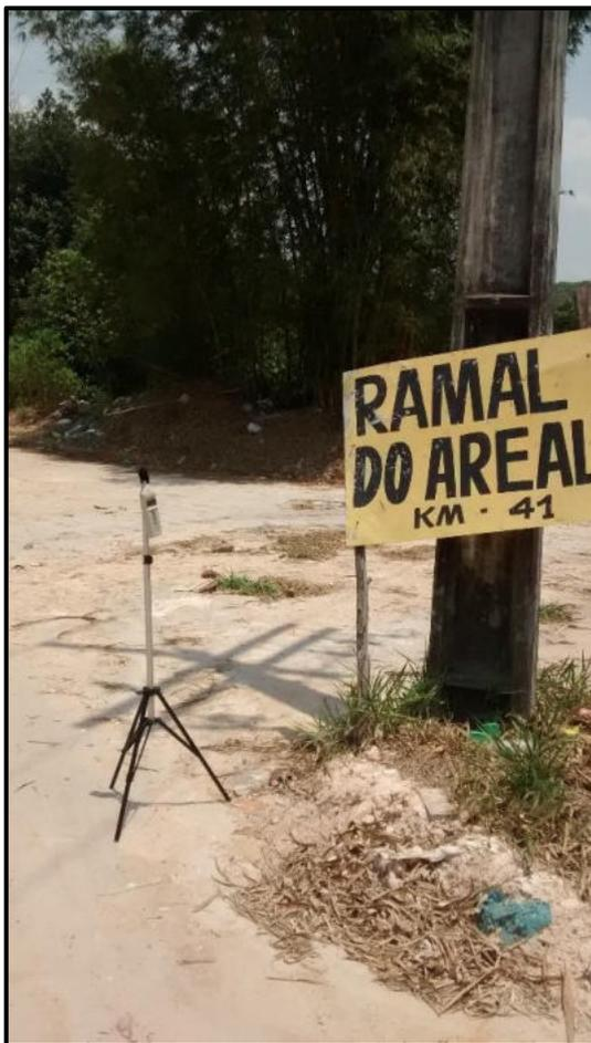
Foto 4.1.4.2.2-3 - Imagem da amostragem durante medição de ruído no ponto P3 (diurno).
