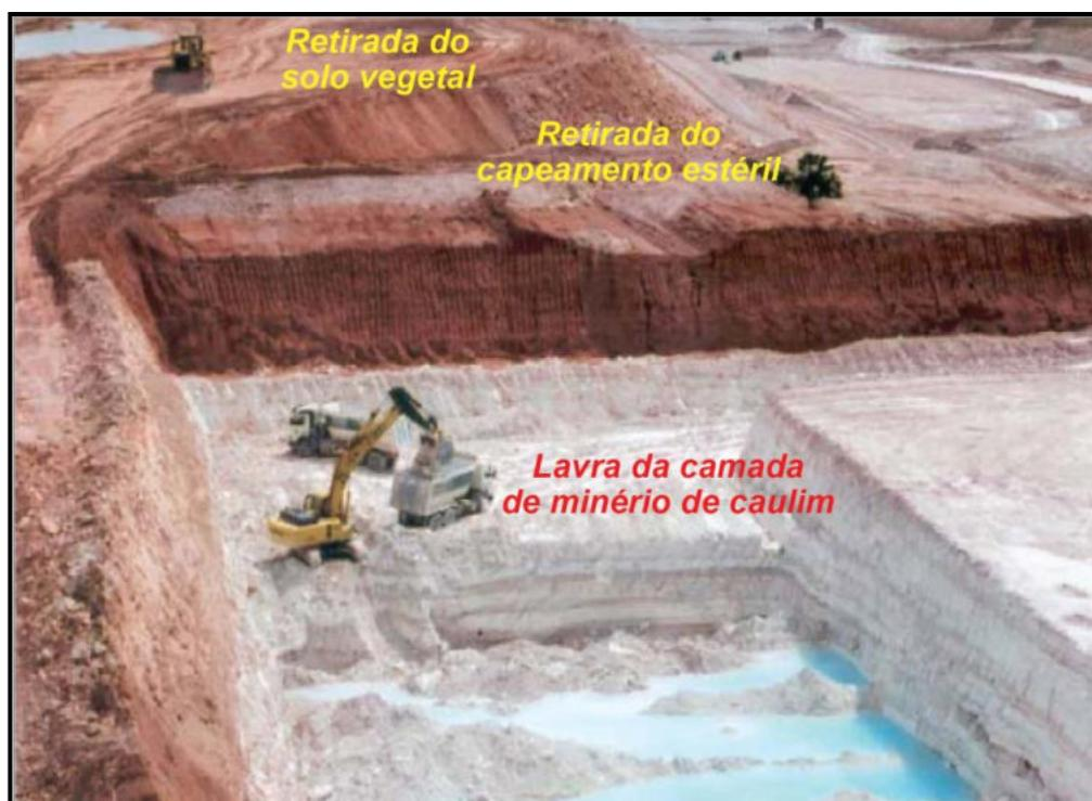
Figura 6.2.3.6-1 - Perfil do terreno em processo de lavra de minério de caulim.
