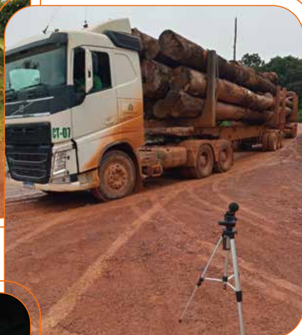
Medição de ruído de dia.
