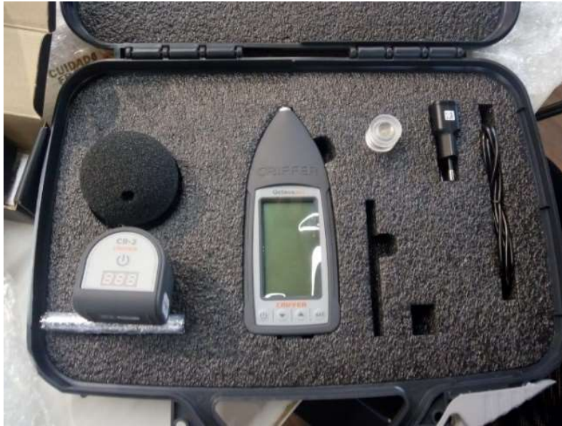
Figura 6-21: Sonômetro modelo Octava-Plus, Marca CRIFFER.
