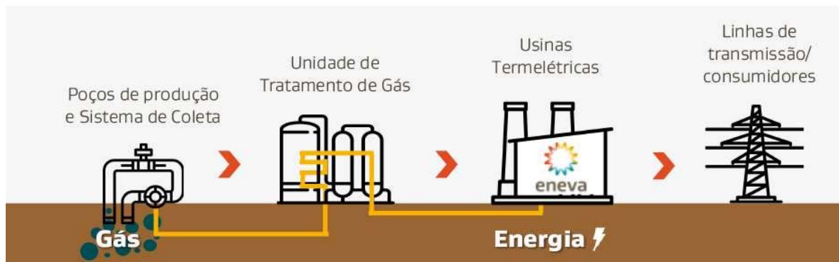
Figura 1-1: Exemplificação do modelo reservoir-to-wire .
