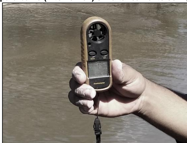
Figura 4-3: Anemômetro para quantificar a intensidade do vento nas seções hidrométricas.
