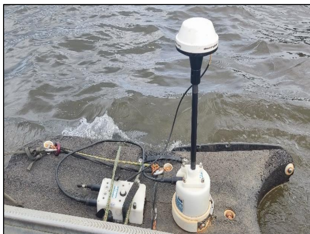
Figura 4-1: Perfilador Acústico Doppler de Corrente (ADCP) modelo M9 da marca SonTek RiverSurveyor acoplado em plataforma flutuante HydroBoard II.
