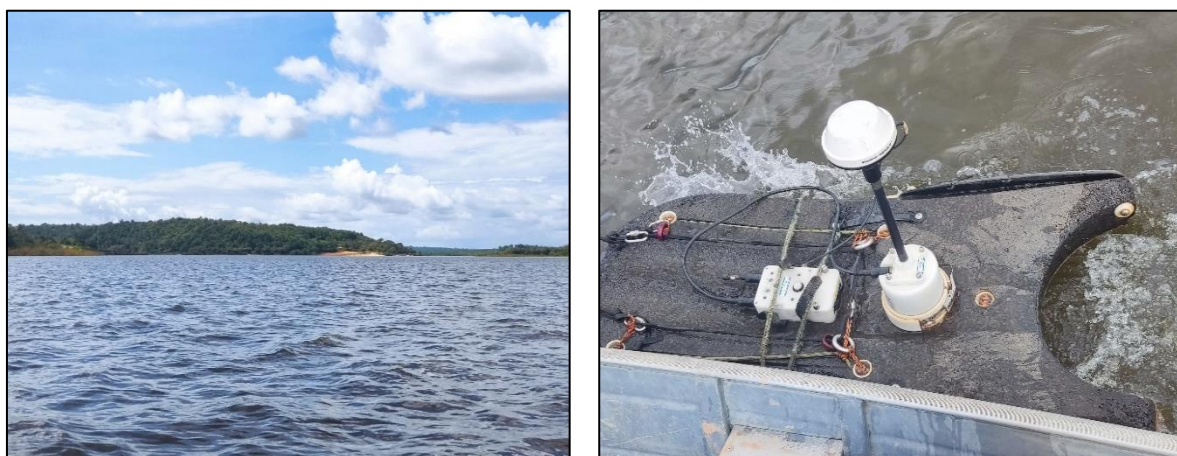
Figura 5-2: Seção hidrométrica de Jusante e travessia com o ADCP M9 acoplado no HydroBoard II.
