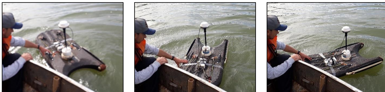
Figura 4-2: Técnico do Laboratório Água e Terra calibrando a bússola através de movimentos ondulados para cima e para baixo (Pitch e Roll) simultaneamente com giros de 360°.
