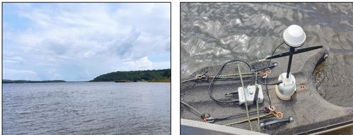
Figura 5-1- Seção hidrométrica de Montante e travessia com o ADCP M9 acoplado no
