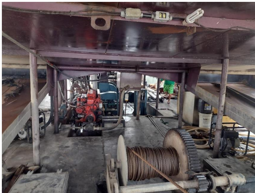
Anexo 7: Foto 2 – Sagu o principal de m quinas do equipamento draga-balsa previsto para atuar na  rea da PLG, em fase de testes. Observar as rampas laterais de fluxo de dragagem e separa o f sica do material de fundo do rio Puru  (Fonte: Equipe T cnica do EIA).
