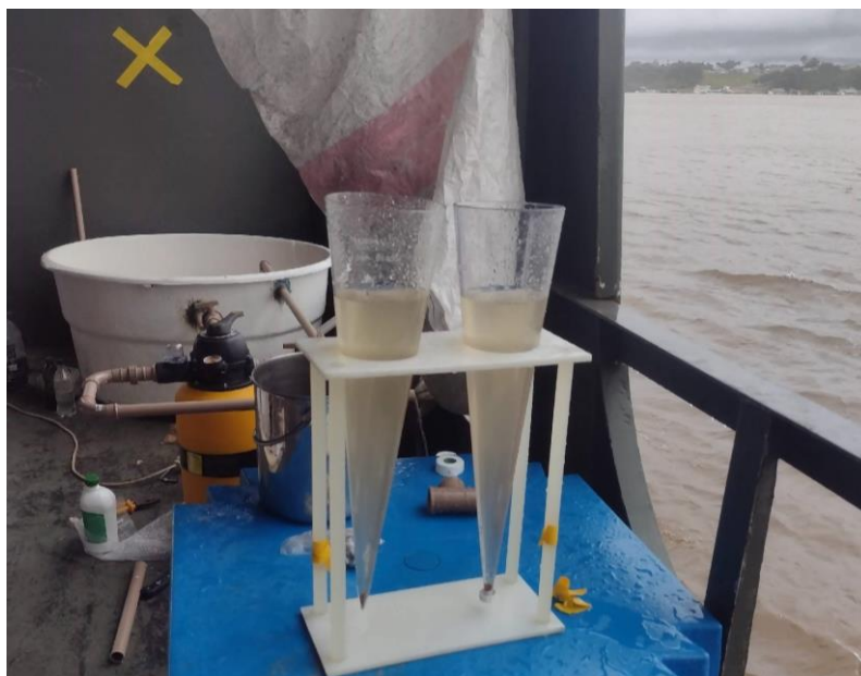
Anexo 5: Foto 1 – Montagem da Mini ETA e início dos estudos comparativo dos rios Japurá – Purué nos sedimentos e material em suspensão. (Fonte: Equipe Técnica do EIA).
