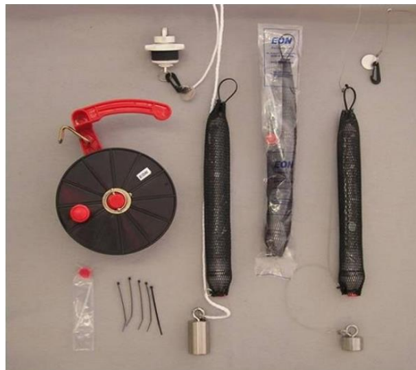
Figura 6 – Imagem ilustrativa do amostrador passivo de difusão para águas subterrâneas, modelo Equilibrator EON , fornecido pelo fabricante AG-SOLVE .
