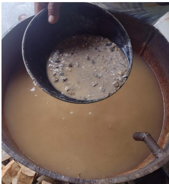
Anexo 6: Foto 8 – Material dragado do fundo do rio Purué e posteriormete peneirado e desagregado com produto químico 'Au21' (Fonte: Equipe Técnica do EIA).
