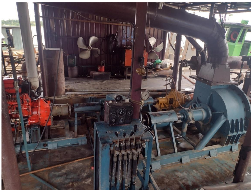
Anexo 7: Foto 3 – Saguão principal de máquinas do equipamento draga-balsa previsto para atuar na área da PLG, em fase de testes. Observar em primeiro plano o painel de controle manual da draga ( Fonte: Equipe Técnica do EIA).
