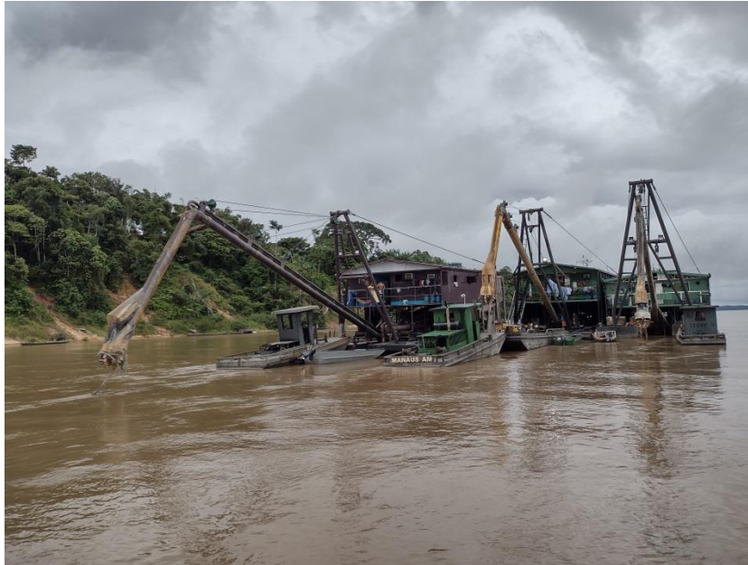
Anexo 7: Foto 1 – Equipamentos draga-balsa previstos para atuarem na  rea da PLG, em fase de testes, durante os trabalhos de campo no rio Puru  (Fonte: Equipe T cnica do EIA).
