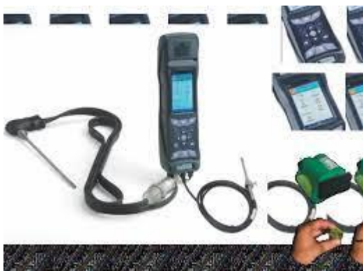
Figura 6 – Imagem ilustrativa do medidor de gases de combustão (CO 2 ), da marca e modelo Ecil chemist 500 compacto e digital.
