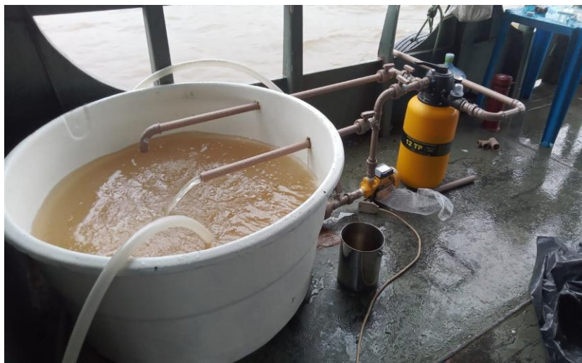
Anexo 6: Foto 3 – Conjunto de equipamentos para tratamento de água e estudo dos sólidos sedimentáveis e dissolvidos funcionando pela primeira vez ( Fonte: Equipe Técnica do EIA).
