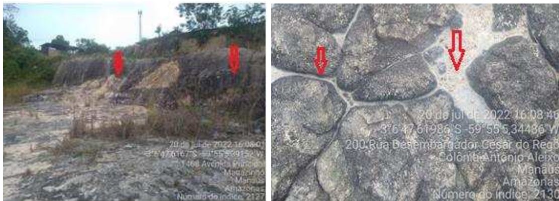
Figura 47 – Evidências de processos erosivos no site da UTE Manau, sendo (C) – Perfil intemperizado contendo latossolo areno-argiloso; (D) – Solo na base do perfil intemperizado com presença de sulcos suscetíveis a erosão
