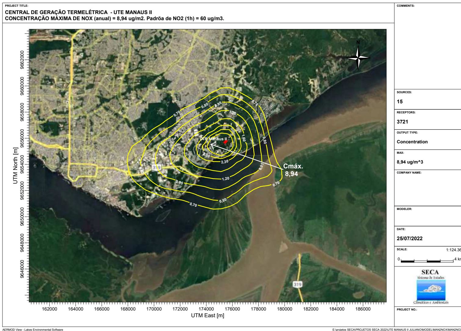
Figura 9.1.2 – UTE Manaus II - Mapa das Isoconcentrações integradas de NO x , médias anuais.
