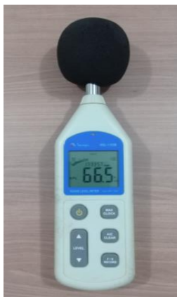
Foto 5. Decibelímetro digital Minipa modelo MSL-1355B a ser utilizado nas medições de campo.
