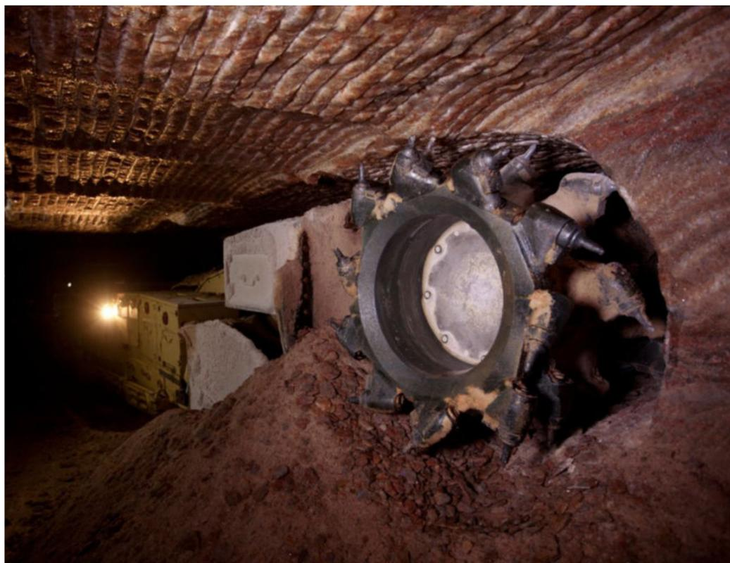
Figura 14: Máquina utilizada na mina subterrânea para desagregar material.
