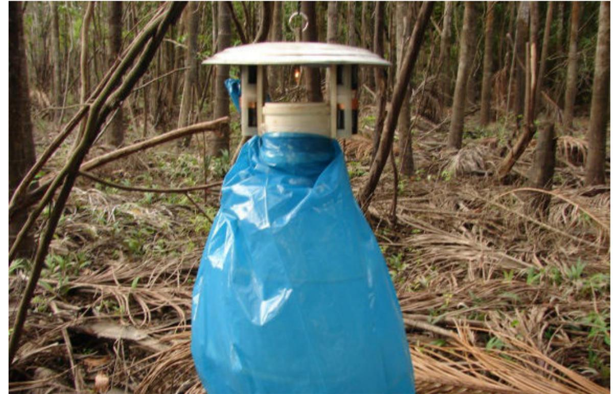
Figura 52: Armadilha para capturar mosquitos.
