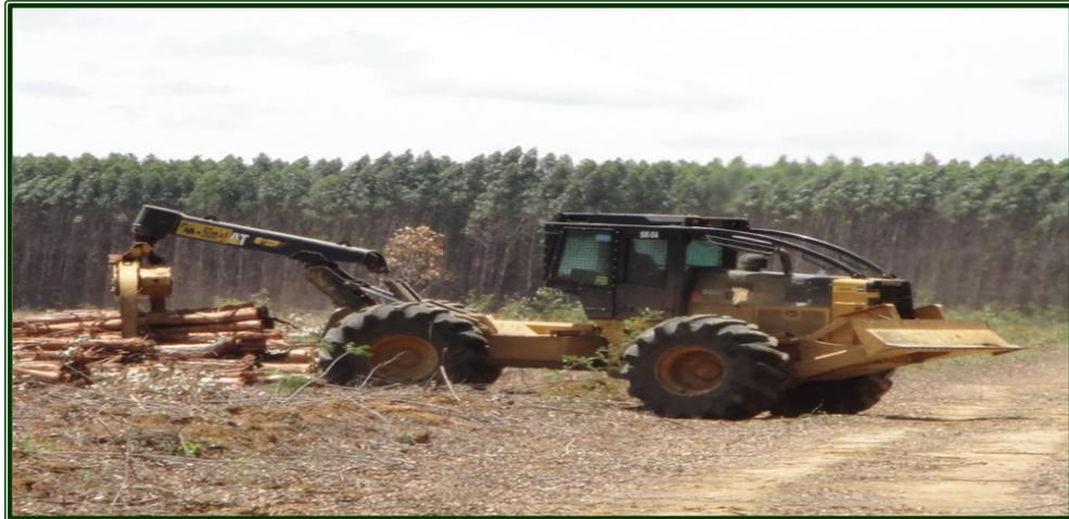
Figura 379 - Trator de pneus “Skidder”, na atividade de transporte de toras de madeiras.
