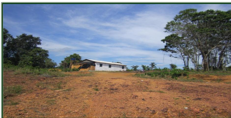
Figura 383- Jazida de Material de 1ª categoria com grande incidência de laterita miúda.
