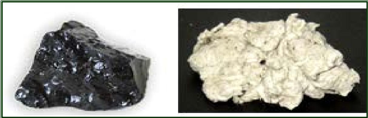
Figura 361 - Exemplos de subprodutos oriundo do gaseificador: Sleg (pedra brita) e fibra isolante. Fonte: Georgia Tech Research Institute.
