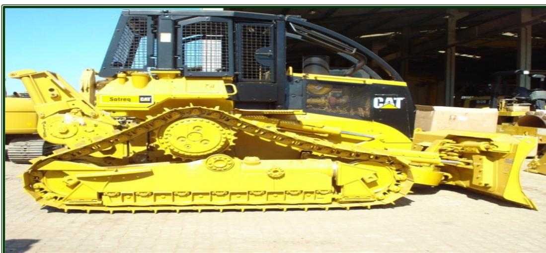
Figura 378 - Trator de esteiras equipado com cabine de proteção para atividades de desmatamento e lâmina angular.
