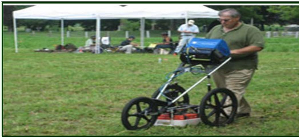
Figura 376 - GPR com antena de 400 MHz para grandes áreas, específico para localização de estruturas de interesse arqueológico e paleontológicos.
