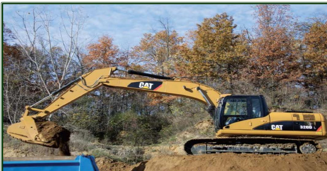
Figura 384 - Escavadeira Hidráulica de esteiras no serviço de corte de material em jazida.
