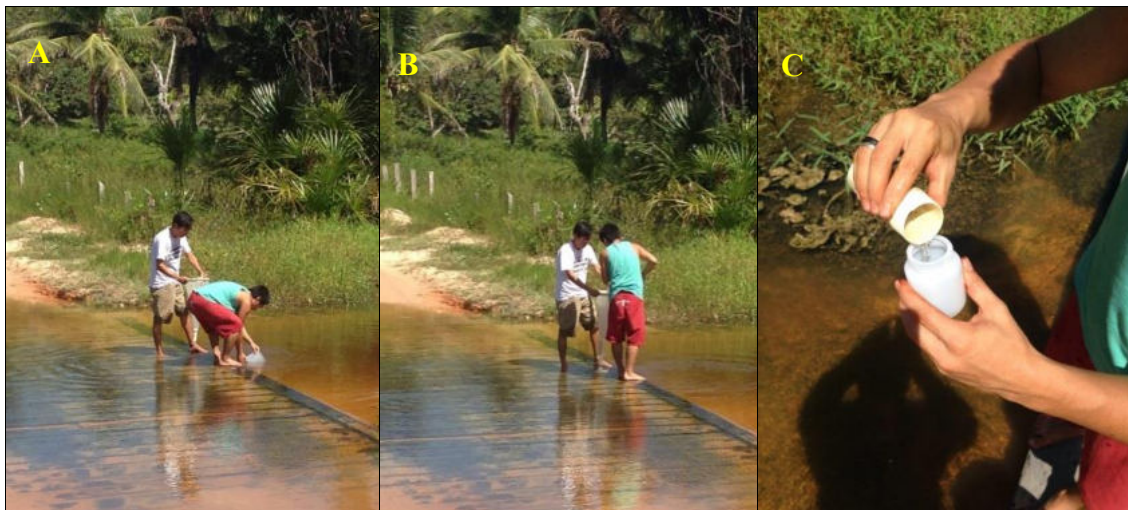
Figura 4.2.2.3.1.1.2-1 - A. amostras sendo coletada em balde de 10 l, 4 vezes; B. Água sendo despejada sobre a rede de fitoplâncton, com abertura de malha de 20 \mu\text{m} ; C. Amostra sendo despejada dentro do pote de polietileno para transporte.
