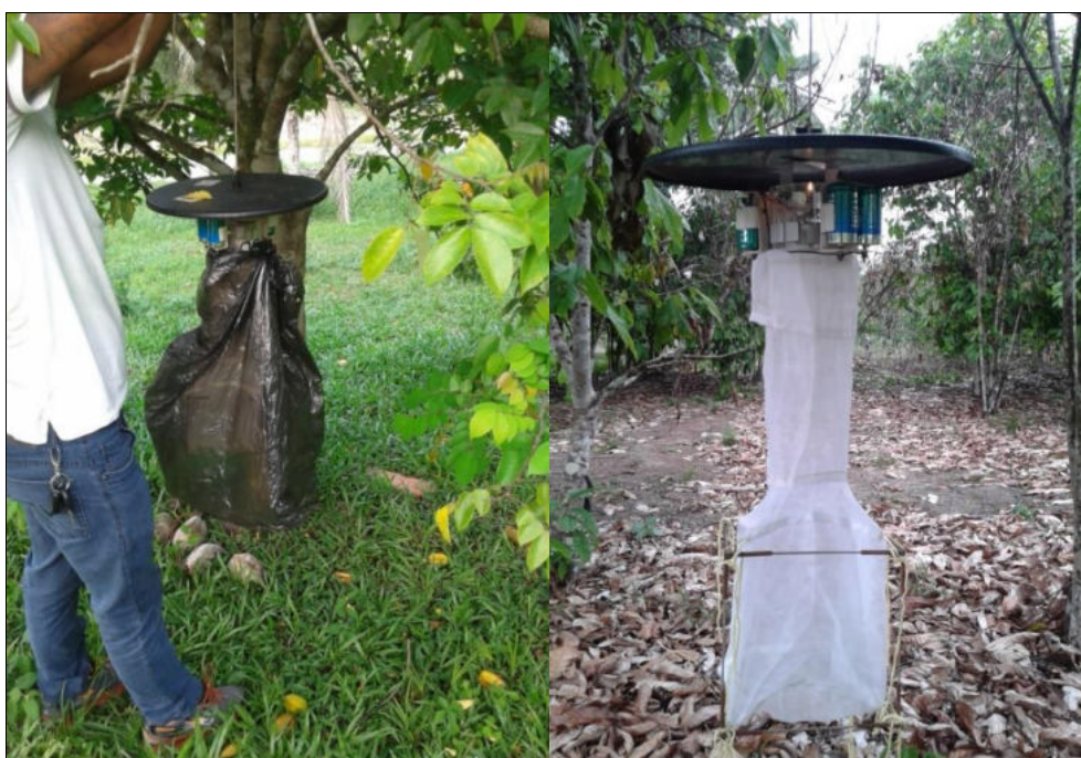
Foto 4.2.1.5.2-2 - Instalação de armadilha luminosa tipo CDC.
